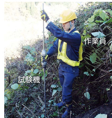
(a) 簡易動的コーン貫入試験機の概要(左: 試験機の寸法 1) , 中: 試験機の写真, 右: 試験の実施状況)
