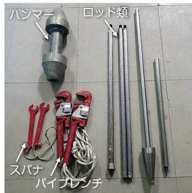
(a) 簡易動的コーン貫入試験機の概要(左: 試験機の寸法 1) , 中: 試験機の写真, 右: 試験の実施状況)
