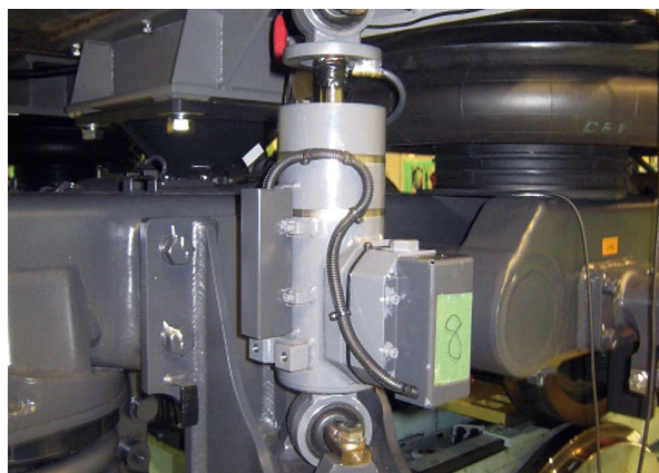
図1 空気ばね台車用の上下動ダンパー
