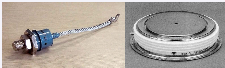
図7 スタッド型(左)と、平型(右)のシリコンダイオード 出典：(右)シリコン整流器, 日本鉄道電気技術協会, 2009
