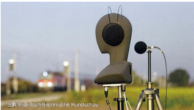
人工頭部測定システムによる聴覚的音響記録
