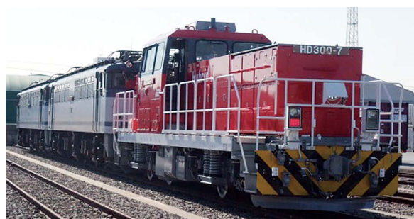
図2 HD300形式ハイブリッド入換専用機関車
