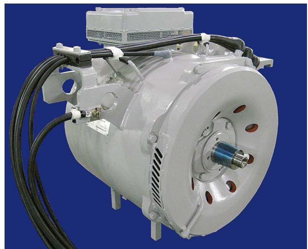
図8 鉄道総研が開発した高効率誘導モーター
