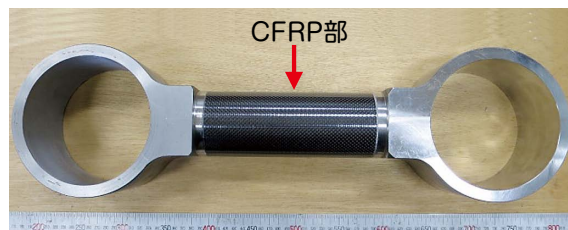
図6 試作したCFRP製一本リンク
