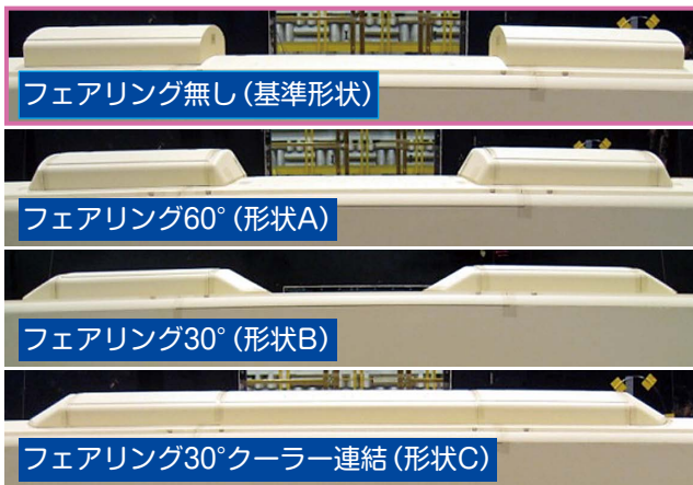
図3 ユニットクーラーの空気抵抗低減策
