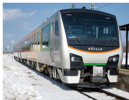
図3 ディーゼルハイブリッド車両 (JR東日本 HB-E300系)
