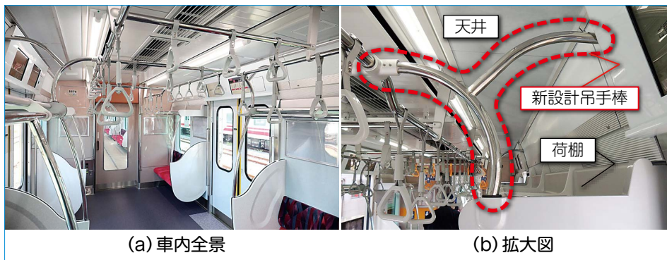
図7 新設計吊手棒の取付状況
