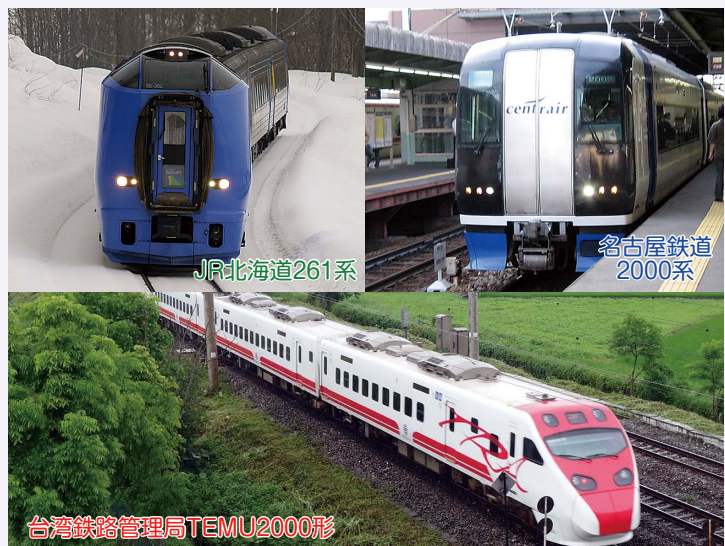
図7 代表的な空気ばね車体傾斜車両
