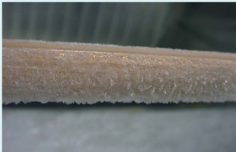
図1 実験で再現された架線着霜
