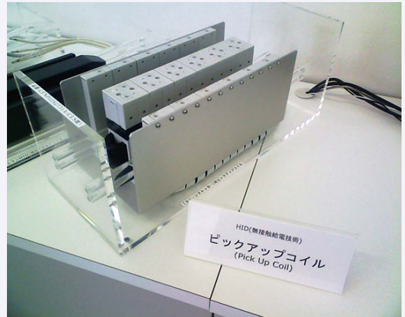
図7 搬送装置用誘導集電装置 (ダイフク工業)
