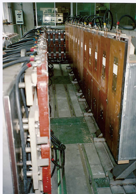
図5 リニア発電機の定置試験の様子
