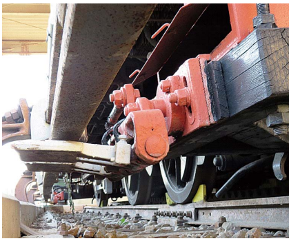
図4 EC40電気機関車の集電靴
