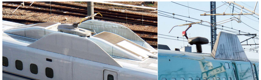
図11 N700系とE5系の低騒音パンタグラフ
