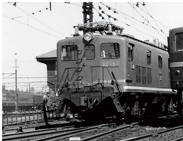
図2 ED45-1機関車(整流器式、低圧タップ切替式)
