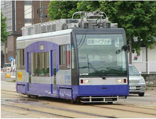
図3 「Hi-tram (ハイ！トラム)」(架線・バッテリーハイブリッドLRV)
