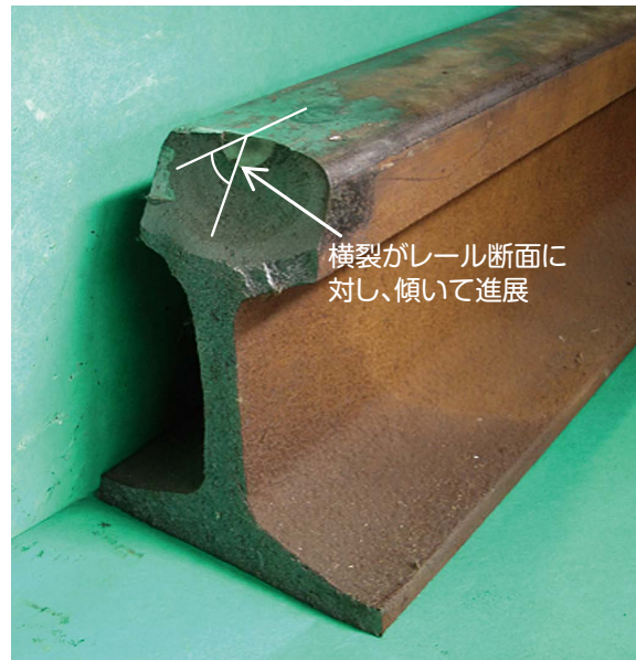
図5 試験による横裂の進展例
