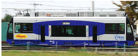
図6 鉄道総研で開発中のバッテリーハイブリッドLRV
