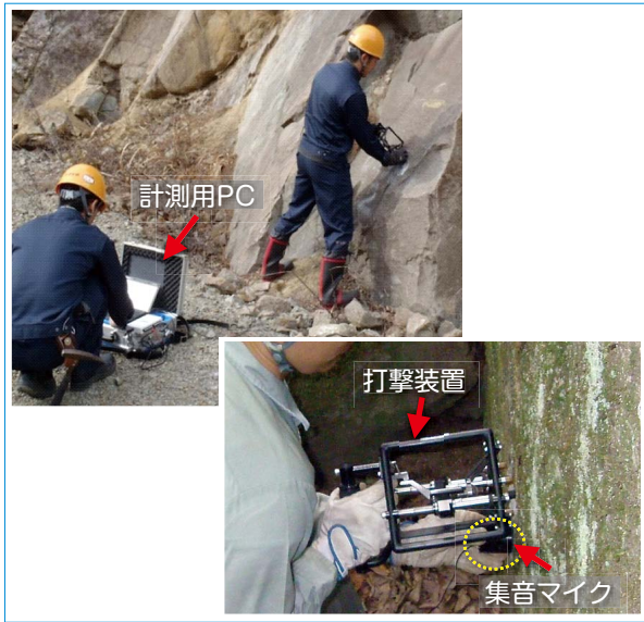
図3 総研式打音検査装置を用いた測定状況
