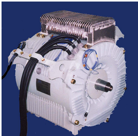
図1 鉄道総研で試作した全閉形永久磁石モーター
