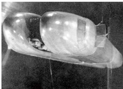
図3 風圧ブレーキ試験
