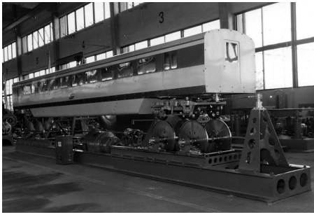
図8 1/5模型車両転走試験装置
