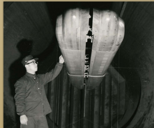
木型模型を用いた風洞試験
