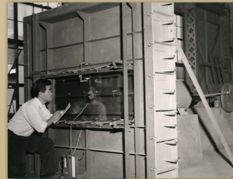
窓ガラスの風圧試験
