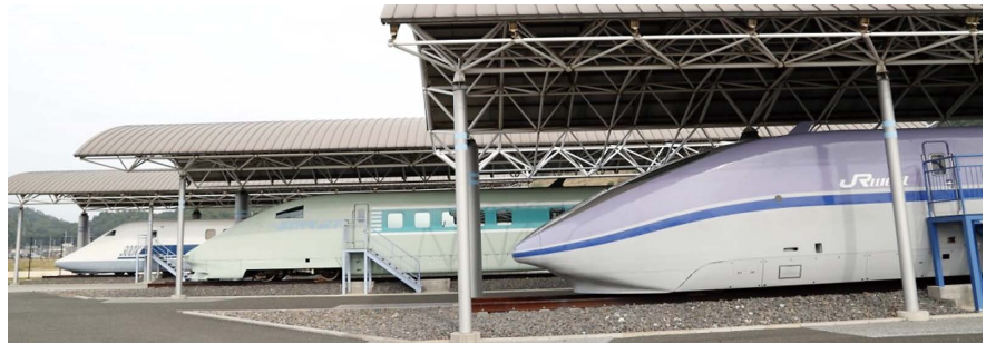
図6 鉄道総研・風洞技術センターに集う新幹線高速試験車 (手前から)・JR西日本 WIN 350：1992年8月8日に山陽新幹線で350km/h。 ・JR東日本 STAR 21：1993年12月21日に上越新幹線で425km/h。 ・JR東海 300X：1996年7月26日に東海道新幹線で443km/h。
