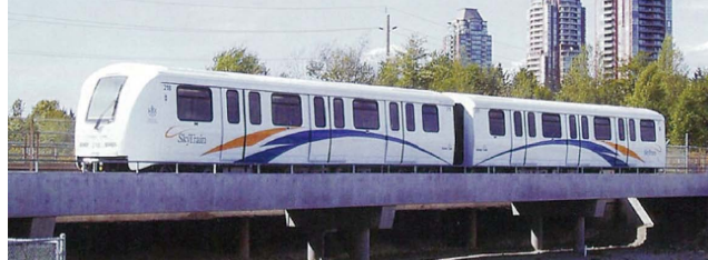
バンクーバーのスカイトレインは、1986年に世界で初めてUTO(無人列車運転)を採用した鉄輪地下鉄である
