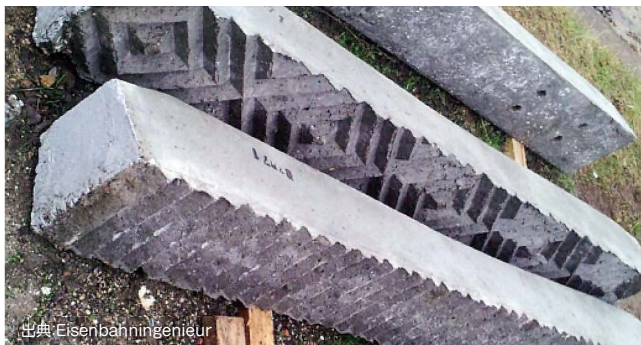
実証実験した菱形溝(上)と直線溝(下)付きのコンクリートまくらぎ
