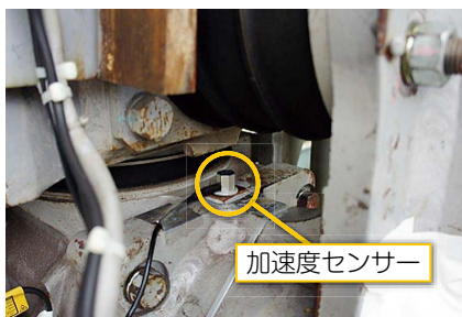
図4 加速度センサー取り付け状況
