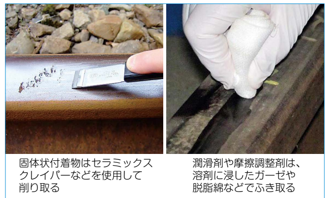
図2 車輪／レール間介在物採取方法の例
