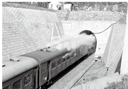
②猿峠トンネルで行われた走行燃焼試験
