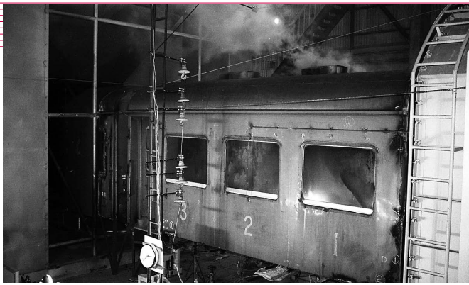
⑤ 燃焼実験棟における模型車体の燃焼試験
