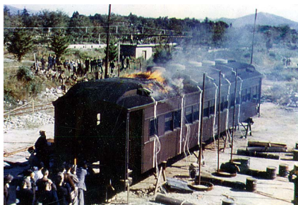
①豊川分工場における木造客車の燃焼試験
