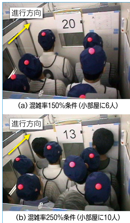
図3 小部屋内の被験者の様子
