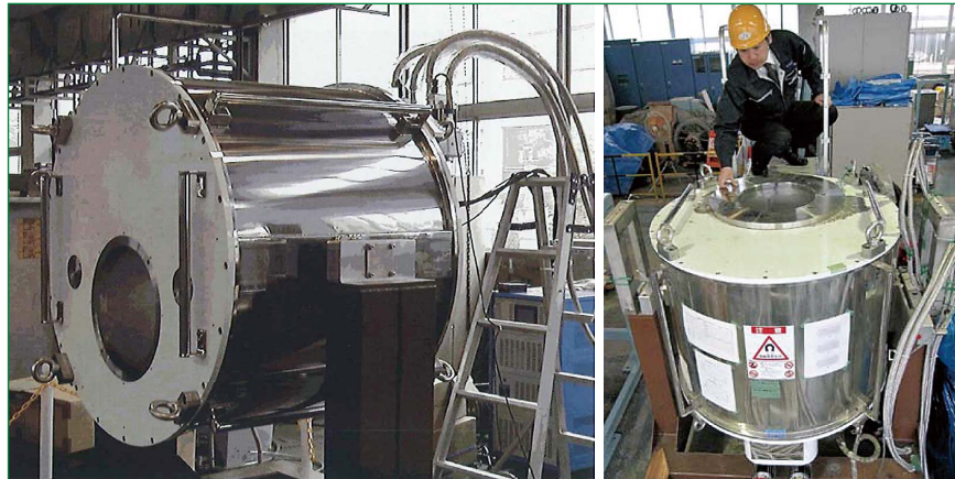
大型5Tマグネット (室温空間径 \phi 400mm)
