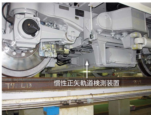
図1 慣性正矢軌道検測装置(台車中央部)
