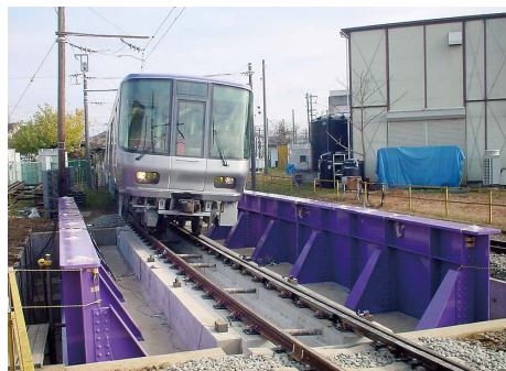
図2 実物大の試験桁における走行試験
