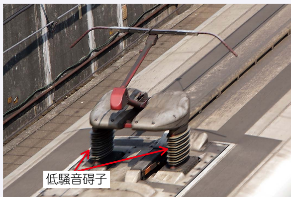
図6 低騒音碍子タイプのシングルアームパンタグラフ (E2系1000番代)
