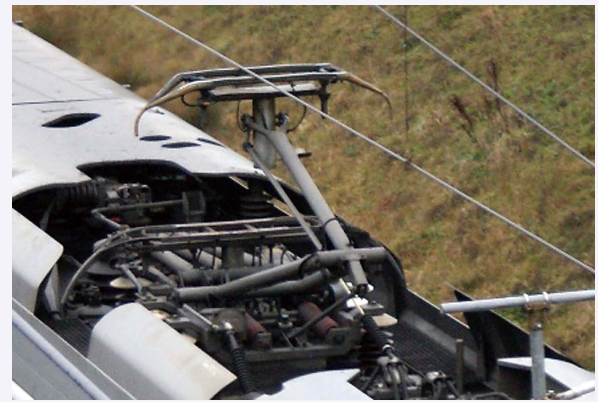
図9 海外の高速用パンタグラフ（フランス、TGV）
