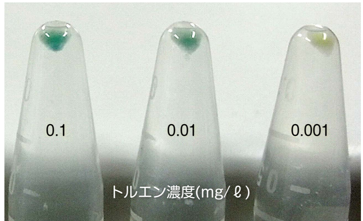
図6 トルエン検知能力 水中のトルエン濃度を下げ、微生物の検知能力を調査した。0.01 mg/l のトルエンを検知して色素が生産された。
