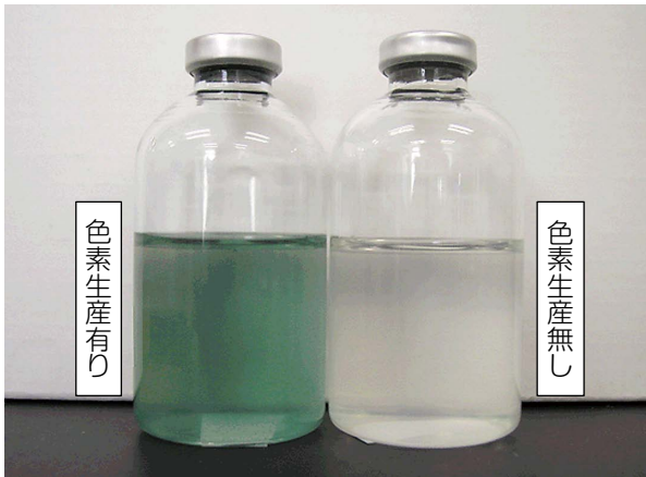
図5 色素を生産するセンサー微生物 トルエンが存在するときは色素を生産する(左)。 トルエンが無いときは無色透明(右)。
