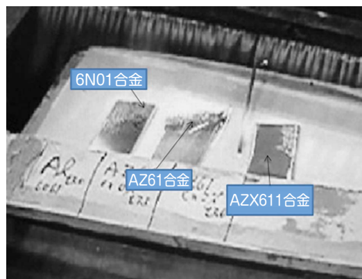
図8 燃焼試験の状況
