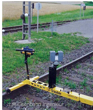
45度回転できるスキャナを用いた測定システム
