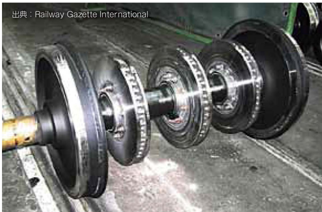
軸重14tで3つのディスクブレーキを有するHEMU-430Xの従軸用輪軸
