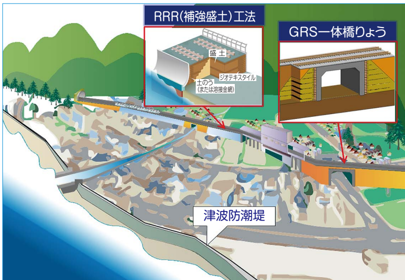
図12 補強土壁工法による鉄道の復旧案
