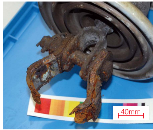
図7 異種金属接触腐食の例
