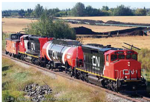
カナダ国鉄 (CN) は LNG 燃料を使用するために改良された EMD SD40-2W 機関車の試用を開始した
