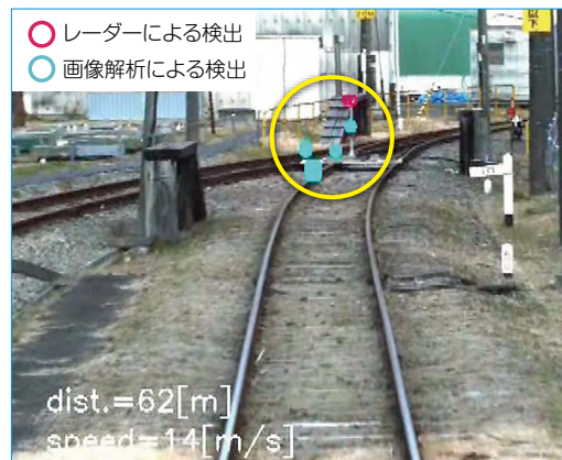
図13 障害物検知結果の画面表示例
