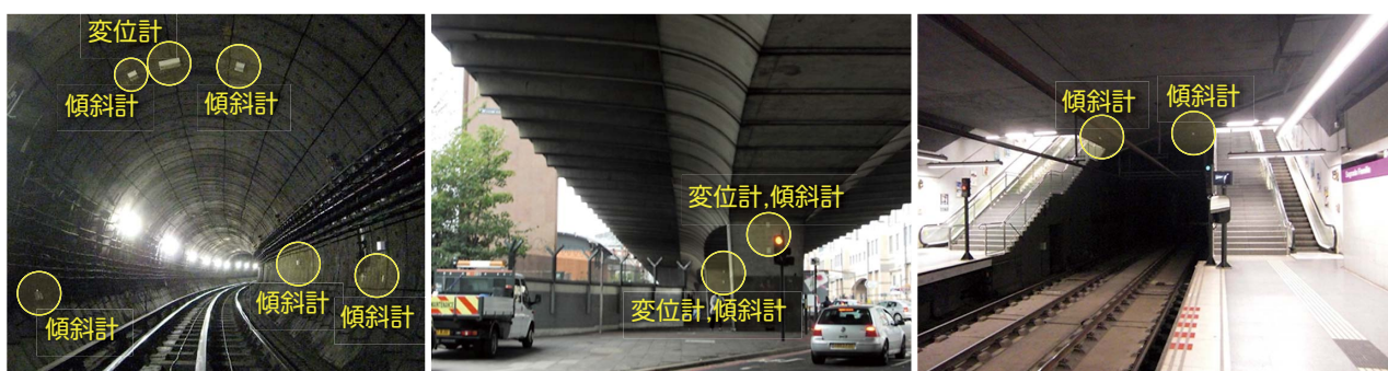
図2 センサーネットワークの導入事例 (黄色円はセンサーの設置箇所)
