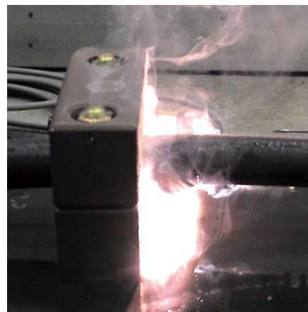
図3 き電ケーブルの焼損再現試験
