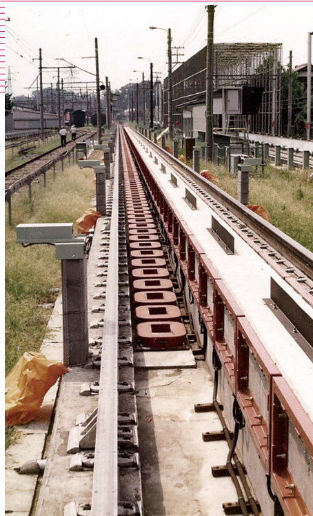
① 走行試験で使用中の ガイドウェイ 所蔵：鉄道総研
