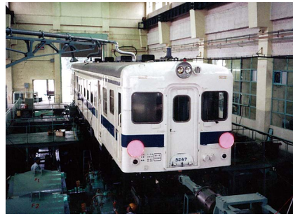
⑤旧車両試験台で走行模擬試験を行うキハ52-47号車 (平成元年)
