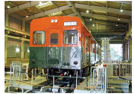
⑥新車両試験台で上下動ダンパーの試験を行うキハ30-15号車 (平成22年)
