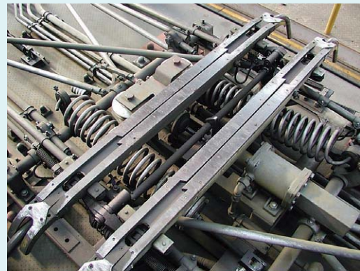
C/C複合材すり板の実車への取付状況
