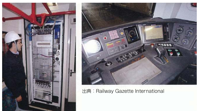
左：メンテナンスのために引き出された車上装置のラック 右：CBTC DMI(ディスプレイ)の表示は実速度、最大速度、目標速度を示す 出典：Railway Gazette International
