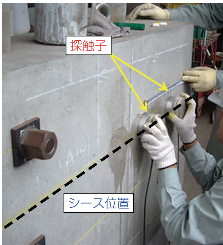
図10 超音波法による実験
