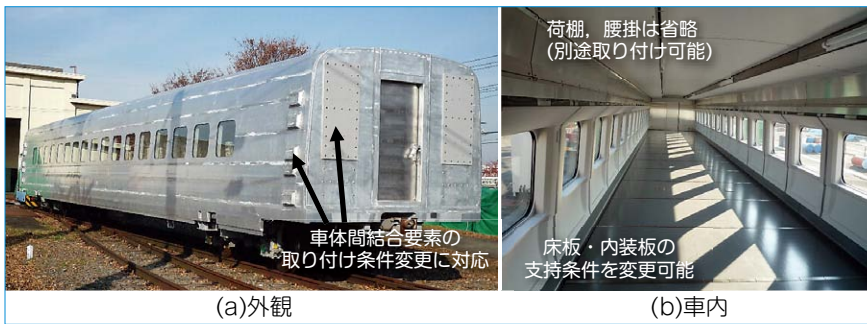
図1 多目的試験車体の外観と車内
