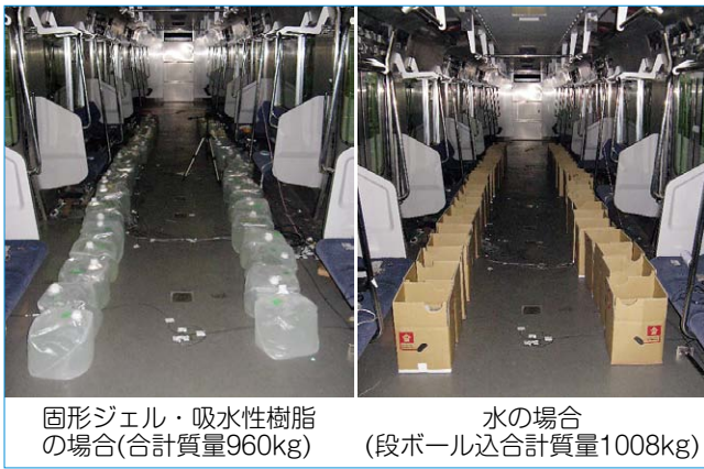
図5 柔軟タンクの積載状況 (20L × 48個)
