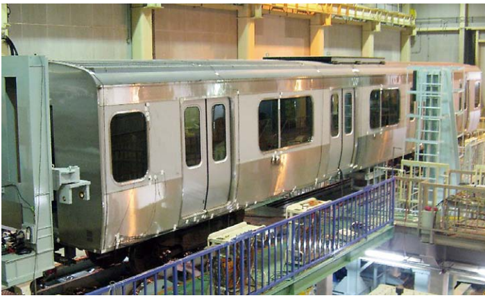
図1 車両試験台における試験車両の加振試験
