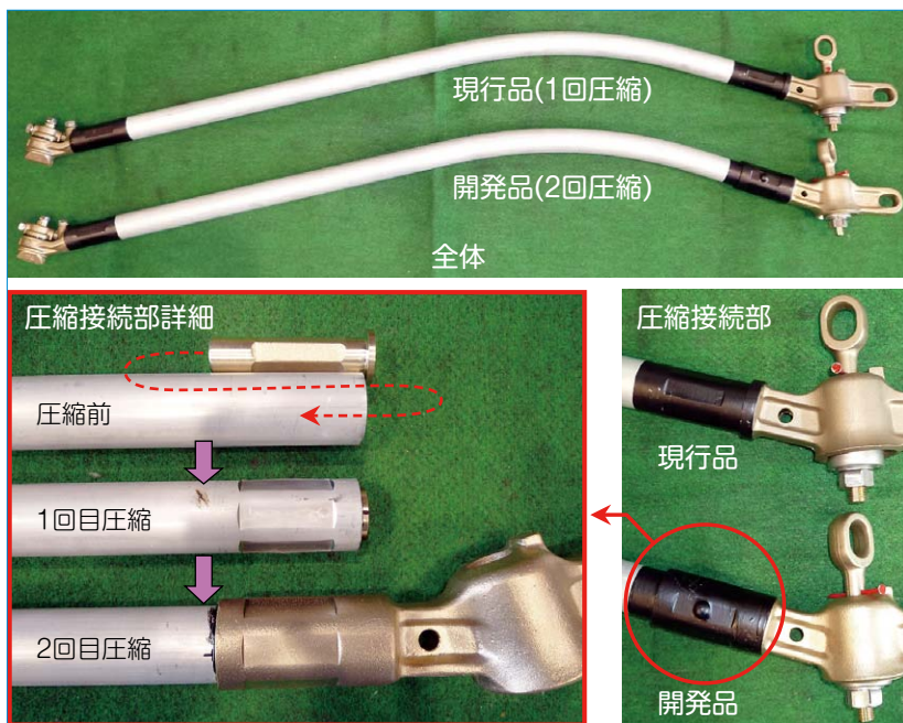
図4 曲線引金具の強度向上
