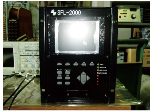
図8 試作した波形処理装置
